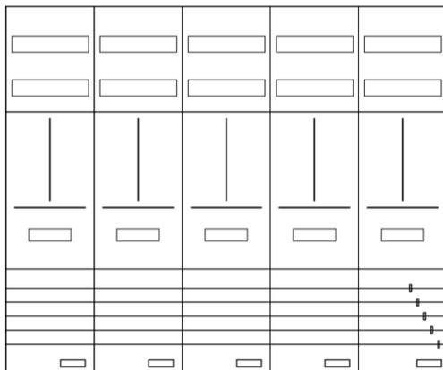
AZ52B-210-5, Zählerverteilung für Zählerplatz mit 3-Punktbefestigung nach VDE 0603, DIN43870, AR-N 4101:2015 für den Innenbereich für Wandbefestigung AP/UP, Fabr. Alphatec, BxHxT [mm] = 1300x1100x210, Schutzklasse II, IP41, RAL 9016, Bestehend aus: Gehäuse, Doppeltür mit Drehriegel, Flansche NF1 (oben) und NF2 (unten) und Berührungsschutzabdeckungen, aufgebaut wie folgt: 5x Zählerplatz, komplett zusammengebaut und verdrahtet gemäß VNB.0001
