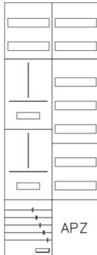
AZ42HS2A-230, Zählerverteilung mit 3-Punktnach VDE 0603, DIN43870, AR-N 4101:2015 für den Innenbereich für Wandbefestigung AP/UP, Fabr. Alphatec, BxHxT [mm] = 550x1400x230, Schutzklasse II, IP54, RAL 7035, Bestehend aus: Gehäuse, Einzel- bzw. Doppeltür mit Drehriegel, Flansche SF45 (oben) und SF41 (unten) und Berührungsschutzabdeckungen, aufgebaut wie folgt: 2xZählerplatz, Verteilerfeld (12TE), APZ in Verteilerfeld, komplett zusammengebaut und verdrahtet gemäß VNB.0174
