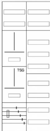
AZ42HS2-210, Zählerverteilung für Zählerplatz mit 3-Punktbefestigung nach VDE 0603, DIN43870, AR-N 4101:2015 für den Innenbereich für Wandbefestigung AP/UP, Fabr. Alphatec, BxHxT [mm] = 550x1400x210, Schutzklasse II, IP41, RAL 9016, Bestehend aus: Gehäuse, Einzeltür mit Drehriegel, Flansche NF1 (oben) und NF2 (unten) und Berührungsschutzabdeckungen, aufgebaut wie folgt: 1x Zählerplatz, 1x TSG-Platte, 9x Hutschienen in Verteilerfeld 1 (12TE), komplett zusammengebaut und verdrahtet gemäß VNB.0001
