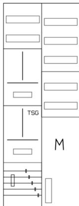
AZ42HS1M1-230, Zählerverteilung mit 3-Punktnach VDE 0603, DIN43870, AR-N 4101:2015 für den Innenbereich für Wandbefestigung AP/UP, Fabr. Alphatec, BxHxT [mm] = 550x1400x230, Schutzklasse II, IP54, RAL 7035, Bestehend aus: Gehäuse, Einzel- bzw. Doppeltür mit Drehriegel, Flansche SF45 (oben) und SF41 (unten) und Berührungsschutzabdeckungen, aufgebaut wie folgt: 1xZählerplatz, TSG, Verteilerfeld (12TE), Medienfeld, externer APZ erforderlich, komplett zusammengebaut und verdrahtet gemäß VNB.0131
