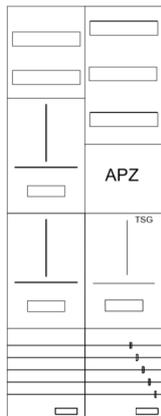
AZ42HS1A-210, Zählerverteilung mit 3-Punktbefestigung nach VDE 0603, DIN43870, AR-N 4101:2015 für den Innenbereich für Wandbefestigung AP/UP, Fabr. Alphatec, BxHxT [mm] = 550x1400x210, Schutzklasse II, IP41, RAL 9016, Bestehend aus: Gehäuse, Einzel- bzw. Doppeltür mit Drehriegel, Flansche NF1 (oben) und NF2 (unten) und Berührungsschutzabdeckungen, aufgebaut wie folgt: 2xZählerplatz, TSG, Verteilerfeld (12TE), APZ in Verteilerfeld, komplett zusammengebaut und verdrahtet gemäß VNB.0051
