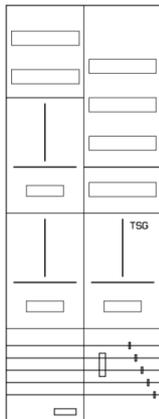
AZ42HS1-230, Zählerverteilung mit 3-Punktnach VDE 0603, DIN43870, AR-N 4101:2015 für den Innenbereich für Wandbefestigung AP/UP, Fabr. Alphatec, BxHxT [mm] = 550x1400x230, Schutzklasse II, IP54, RAL 7035, Bestehend aus: Gehäuse, Einzel- bzw. Doppeltür mit Drehriegel, Flansche SF45 (oben) und SF41 (unten) und Berührungsschutzabdeckungen, aufgebaut wie folgt: 2xZählerplatz, TSG, Verteilerfeld (12TE), externer APZ erforderlich, komplett zusammengebaut und verdrahtet gemäß VNB.0130
