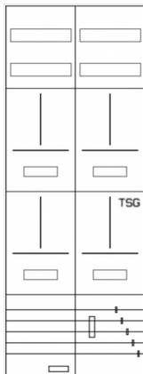
AZ42H-230, Zählerverteilung mit 3-Punktnach VDE 0603, DIN43870, AR-N 4101:2015 für den Innenbereich für Wandbefestigung AP/UP, Fabr. Alphatec, BxHxT [mm] = 550x1400x230, Schutzklasse II, IP54, RAL 7035, Bestehend aus: Gehäuse, Einzel- bzw. Doppeltür mit Drehriegel, Flansche SF45 (oben) und SF41 (unten) und Berührungsschutzabdeckungen, aufgebaut wie folgt: 3xZählerplatz, TSG, externer APZ erforderlich, komplett zusammengebaut und verdrahtet gemäß VNB.0128
