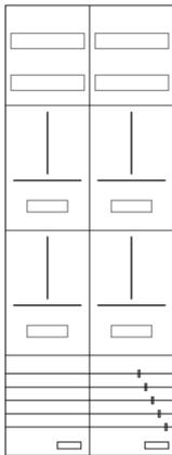
AZ42H-210-4, Zählerverteilung für Zählerplatz mit 3-Punktbefestigung nach VDE 0603, DIN43870, AR-N 4101:2015 für den Innenbereich für Wandbefestigung AP/UP, Fabr. Alphatec, BxHxT [mm] = 550x1400x210, Schutzklasse II, IP41, RAL 9016, Bestehend aus: Gehäuse, Einzeltür mit Drehriegel, Flansche NF1 (oben) und NF2 (unten) und Berührungsschutzabdeckungen, aufgebaut wie folgt: 4x Zählerplatz, komplett zusammengebaut und verdrahtet gemäß VNB.0001
