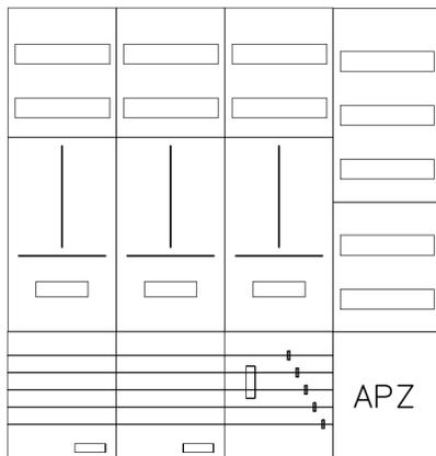
AZ42BSA-230-2, Zählerverteilung mit 3-Punktnach VDE 0603, DIN43870, AR-N 4101:2015 für den Innenbereich für Wandbefestigung AP/UP, Fabr. Alphatec, BxHxT [mm] = 550x1100x230, Schutzklasse II, IP54, RAL 7035, Bestehend aus: Gehäuse, Einzel- bzw. Doppeltür mit Drehriegel, Flansche SF45 (oben) und SF41 (unten) und Berührungsschutzabdeckungen, aufgebaut wie folgt: 3xZählerplatz, Verteilerfeld (12TE), APZ in Verteilerfeld, komplett zusammgebaut und verdrahtet gemäß VNB.0171
