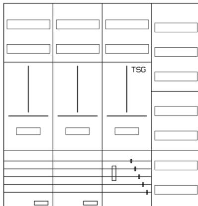
AZ42BS-210, Zählerverteilung für Zählerplatz mit 3-Punktbefestigung nach VDE 0603, DIN43870, AR-N 4101:2015 für den Innenbereich für Wandbefestigung AP/UP, Fabr. Alphatec, BxHxT [mm] = 1050x1100x210, Schutzklasse II, IP41, RAL 9016, Bestehend aus: Gehäuse, Doppeltür mit Drehriegel, Flansche NF1 (oben) und NF2 (unten) und Berührungsschutzabdeckungen, aufgebaut wie folgt: 2x Zählerplatz, 1x TSG-Platte, 7x Hutschienen in Verteilerfeld 1 (12TE), komplett zusammengebaut und verdrahtet gemäß VNB.0001
