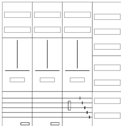
AZ42BS-210-2, Zählerverteilung mit 3-Punktbefestigung nach VDE 0603, DIN43870, AR-N 4101:2015 für den Innenbereich für Wandbefestigung AP/UP, Fabr. Alphatec, BxHxT [mm] = 550x1100x210, Schutzklasse II, IP41, RAL 9016, Bestehend aus: Gehäuse, Einzel- bzw. Doppeltür mit Drehriegel, Flansche NF1 (oben) und NF2 (unten) und Berührungsschutzabdeckungen, aufgebaut wie folgt: 3xZählerplatz, Verteilerfeld (12TE), externer APZ erforderlich, komplett zusammengebaut und verdrahtet gemäß VNB.0049
