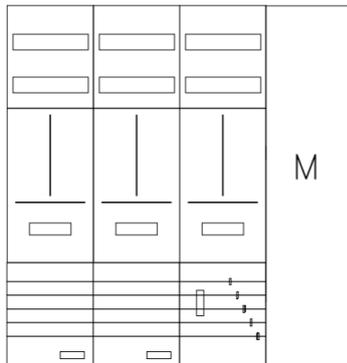
AZ42BM-230-2, Zählerverteilung mit 3-Punktnach VDE 0603, DIN43870, AR-N 4101:2015 für den Innenbereich für Wandbefestigung AP/UP, Fabr. Alphatec, BxHxT [mm] = 550x1100x230, Schutzklasse II, IP54, RAL 7035, Bestehend aus: Gehäuse, Einzel- bzw. Doppeltür mit Drehriegel, Flansche SF45 (oben) und SF41 (unten) und Berührungsschutzabdeckungen, aufgebaut wie folgt: 3xZählerplatz, Medienfeld, externer APZ erforderlich, komplett zusammengebaut und verdrahtet gemäß VNB.0167
