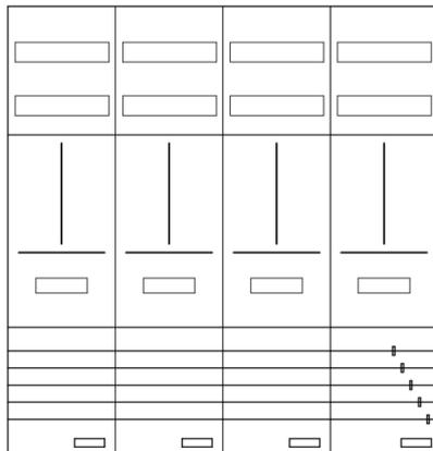
AZ42B-230-4, Zählerverteilung für Zählerplatz mit 3-Punktbefestigung nach VDE 0603, DIN43870, AR-N 4101:2015 für den Innenbereich für Wandbefestigung AP/UP, Fabr. Alphatec, BxHxT [mm] = 1050x1100x230, Schutzklasse II, IP54, RAL 7035, Bestehend aus: Gehäuse, Doppeltür mit Drehriegel, Flansche SF45 (oben) und SF41 (unten) und Berührungsschutzabdeckungen, aufgebaut wie folgt: 4x Zählerplatz, komplett zusammengebaut und verdrahtet gemäß VNB.0001
