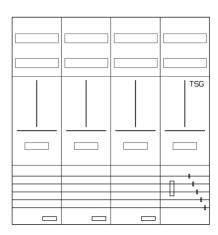
AZ42B-210, Zählerverteilung für Zählerplatz mit 3-Punktbefestigung nach VDE 0603, DIN43870, AR-N 4101:2015 für den Innenbereich für Wandbefestigung AP/UP, Fabr. Alphatec, BxHxT [mm] = 1050x1100x210, Schutzklasse II, IP41, RAL 9016, Bestehend aus: Gehäuse, Doppeltür mit Drehriegel, Flansche NF1 (oben) und NF2 (unten) und Berührungsschutzabdeckungen, aufgebaut wie folgt: 3x Zählerplatz, 1x TSG-Platte, komplett zusammengebaut und verdrahtet gemäß VNB.0001
