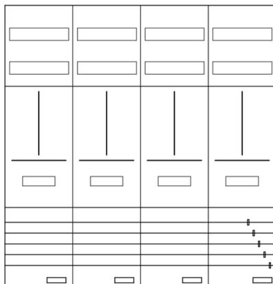
AZ42B-210-4, Zählerverteilung für Zählerplatz mit 3-Punktbefestigung nach VDE 0603, DIN43870, AR-N 4101:2015 für den Innenbereich für Wandbefestigung AP/UP, Fabr. Alphatec, BxHxT [mm] = 1050x1100x210, Schutzklasse II, IP41, RAL 9016, Bestehend aus: Gehäuse, Doppeltür mit Drehriegel, Flansche NF1 (oben) und NF2 (unten) und Berührungsschutzabdeckungen, aufgebaut wie folgt: 4x Zählerplatz, komplett zusammengebaut und verdrahtet gemäß VNB.0001
