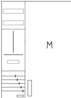
AZ32BMM-230, Zählerverteilung für Zählerplatz mit 3-Punktbefestigung nach VDE 0603, DIN43870, AR-N 4101:2015 für den Innenbereich für Wandbefestigung AP/UP, Fabr. Alphatec, BxHxT [mm] = 800x1100x230, Schutzklasse II, IP54, RAL 7035, Bestehend aus: Gehäuse, Doppeltür mit Drehriegel, Flansche SF45 (oben) und SF41 (unten) und Berührungsschutzabdeckungen, aufgebaut wie folgt: 1x Zählerplatz, , 7x HE in Medienfeld 2 Feld, komplett zusammengebaut und verdrahtet gemäß VNB.0001
