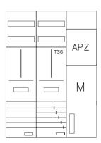
AZ32BMA-230, Zählerverteilung mit 3-Punktnach VDE 0603, DIN43870, AR-N 4101:2015 für den Innenbereich für Wandbefestigung AP/UP, Fabr. Alphatec, BxHxT [mm] = 800x1100x230, Schutzklasse II, IP54, RAL 7035, Bestehend aus: Gehäuse, Einzel- bzw. Doppeltür mit Drehriegel, Flansche SF45 (oben) und SF41 (unten) und Berührungsschutzabdeckungen, aufgebaut wie folgt: 1xZählerplatz, TSG, APZ in Medienfeld, komplett zusammengebaut und verdrahtet gemäß VNB.0164
