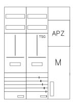
AZ32BMA-210, Zählerverteilung mit 3-Punktbefestignach VDE 0603, DIN43870, AR-N 4101:2015 für den Innenbereich für Wandbefestigung AP/UP, Fabr. Alphatec, BxHxT [mm] = 800x1100x210, Schutzklasse II, IP41, RAL 9016, Bestehend aus: Gehäuse, Einzel- bzw. Doppeltür mit Drehriegel, Flansche NF1 (oben) und NF2 (unten) und Berührungsschutzabdeckungen, aufgebaut wie folgt: 1xZählerplatz, TSG, APZ in Medienfeld, komplett zusammengebaut und verdrahtet gemäß VNB.0043
