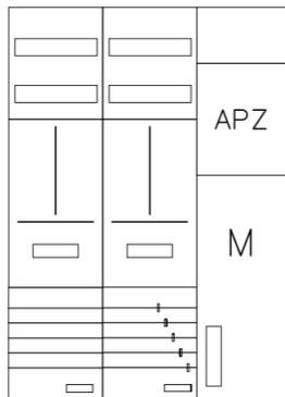
AZ32BMA-210-2, Zählerverteilung mit 3-Punktbefestigung nach VDE 0603, DIN43870, AR-N 4101:2015 für den Innenbereich für Wandbefestigung AP/UP, Fabr. Alphatec, BxHxT [mm] = 800x1100x210, Schutzklasse II, IP41, RAL 9016, Bestehend aus: Gehäuse, Einzel- bzw. Doppeltür mit Drehriegel, Flansche NF1 (oben) und NF2 (unten) und Berührungsschutzabdeckungen, aufgebaut wie folgt: 2xZählerplatz, APZ in Medienfeld, komplett zusammengebaut und verdrahtet gemäß VNB.0044
