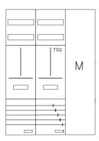
AZ32BM-230, Zählerverteilung mit 3-Punktnach VDE 0603, DIN43870, AR-N 4101:2015 für den Innenbereich für Wandbefestigung AP/UP, Fabr. Alphatec, BxHxT [mm] = 800x1100x230, Schutzklasse II, IP54, RAL 7035, Bestehend aus: Gehäuse, Einzel- bzw. Doppeltür mit Drehriegel, Flansche SF45 (oben) und SF41 (unten) und Berührungsschutzabdeckungen, aufgebaut wie folgt: 1xZählerplatz, TSG, Medienfeld, externer APZ erforderlich, komplett zusammengebaut und verdrahtet gemäß VNB.0162
