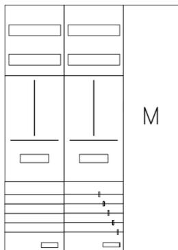
AZ32BM-230-2, Zählerverteilung mit 3-Punktnach VDE 0603, DIN43870, AR-N 4101:2015 für den Innenbereich für Wandbefestigung AP/UP, Fabr. Alphatec, BxHxT [mm] = 800x1100x230, Schutzklasse II, IP54, RAL 7035, Bestehend aus: Gehäuse, Einzel- bzw. Doppeltür mit Drehriegel, Flansche SF45 (oben) und SF41 (unten) und Berührungsschutzabdeckungen, aufgebaut wie folgt: 2xZählerplatz, Medienfeld, externer APZ erforderlich, komplett zusammengebaut und verdrahtet gemäß VNB.0163
