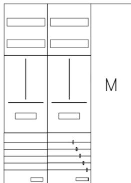
AZ32BM-210-2, Zählerverteilung mit 3-Punktbefestigung nach VDE 0603, DIN43870, AR-N 4101:2015 für den Innenbereich für Wandbefestigung AP/UP, Fabr. Alphatec, BxHxT [mm] = 800x1100x210, Schutzklasse II, IP41, RAL 9016, Bestehend aus: Gehäuse, Einzel- bzw. Doppeltür mit Drehriegel, Flansche NF1 (oben) und NF2 (unten) und Berührungsschutzabdeckungen, aufgebaut wie folgt: 2xZählerplatz, Medienfeld, externer APZ erforderlich, komplett zusammengesetzt und verdrahtet gemäß VNB.0042
