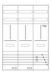
AZ32B-230, Zählerverteilung für Zählerplatz mit 3-Punktbefestigung nach VDE 0603, DIN43870, AR-N 4101:2015 für den Innenbereich für Wandbefestigung AP/UP, Fabr. Alphatec, BxHxT [mm] = 800x1100x230, Schutzklasse II, IP54, RAL 7035, Bestehend aus: Gehäuse, Doppeltür mit Schwenkhebel für Profilhalbzylinder, Flansche SF45 (oben) und SF41 (unten) und Berührungsschutzabdeckungen, aufgebaut wie folgt: 2x Zählerplatz, 1x TSG-Platte, komplett zusammengebaut und verdrahtet gemäß VNB.0001
