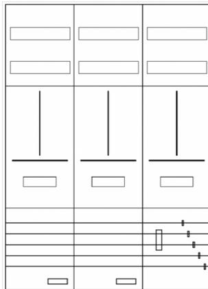
AZ32B-230-3, Zählerverteilung für Zählerplatz mit 3-Punktbefestigung nach VDE 0603, DIN43870, AR-N 4101:2015 für den Innenbereich für Wandbefestigung AP/UP, Fabr. Alphatec, BxHxT [mm] = 800x1100x230, Schutzklasse II, IP54, RAL 7035, Bestehend aus: Gehäuse, Doppeltür mit Drehriegel, Flansche SF45 (oben) und SF41 (unten) und Berührungsschutzabdeckungen, aufgebaut wie folgt: 3x Zählerplatz, komplett zusammengebaut und verdrahtet gemäß VNB.0001
