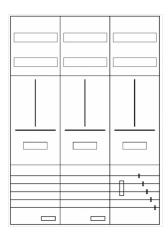
AZ32B-210-3, Zählerverteilung für Zählerplatz mit 3-Punktbefestigung nach VDE 0603, DIN43870, AR-N 4101:2015 für den Innenbereich für Wandbefestigung AP/UP, Fabr. Alphatec, BxHxT [mm] = 800x1100x210, Schutzklasse II, IP41, RAL 9016, Bestehend aus: Gehäuse, Doppeltür mit Drehriegel, Flansche NF1 (oben) und NF2 (unten) und Berührungsschutzabdeckungen, aufgebaut wie folgt: 3x Zählerplatz, komplett zusammengebaut und verdrahtet gemäß VNB.0001
