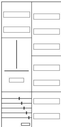
AZ22BS-210, Zählerverteilung für Zählerplatz mit 3-Punktbefestigung nach VDE 0603, DIN43870, AR-N 4101:2015 für den Innenbereich für Wandbefestigung AP/UP, Fabr. Alphatec, BxHxT [mm] = 550x1100x210, Schutzklasse II, IP41, RAL 9016, Bestehend aus: Gehäuse, Einzeltür mit Drehriegel, Flansche NF1 (oben) und NF2 (unten) und Berührungsschutzabdeckungen, aufgebaut wie folgt: 1x Zählerplatz, 7x Hutschienen in Verteilerfeld 1 (12TE), komplett zusammengebaut und verdrahtet gemäß VNB.0001
