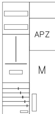
AZ22BMA-210, Zählerverteilung mit 3-Punktbefestigung nach VDE 0603, DIN43870, AR-N 4101:2015 für den Innenbereich für Wandbefestigung AP/UP, Fabr. Alphatec, BxHxT [mm] = 550x1100x210, Schutzklasse II, IP41, RAL 9016, Bestehend aus: Gehäuse, Einzel- bzw. Doppeltür mit Drehriegel, Flansche NF1 (oben) und NF2 (unten) und Berührungsschutzabdeckungen, aufgebaut wie folgt: 1xZählerplatz, APZ in Medienfeld, komplett zusammengebaut und verdrahtet gemäß VNB.0040
