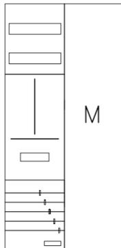
AZ22BM-230, Zählerverteilung mit 3-Punktnach VDE 0603, DIN43870, AR-N 4101:2015 für den Innenbereich für Wandbefestigung AP/UP, Fabr. Alphatec, BxHxT [mm] = 550x1100x230, Schutzklasse II, IP54, RAL 7035, Bestehend aus: Gehäuse, Einzel- bzw. Doppeltür mit Drehriegel, Flansche SF45 (oben) und SF41 (unten) und Berührungsschutzabdeckungen, aufgebaut wie folgt: 1xZählerplatz, Medienfeld, externer APZ erforderlich, komplett zusammengebaut und verdrahtet gemäß VNB.0160
