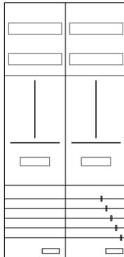
AZ22B-210-2, Zählerverteilung für Zählerplatz mit 3-Punktbefestigung nach VDE 0603, DIN43870, AR-N 4101:2015 für den Innenbereich für Wandbefestigung AP/UP, Fabr. Alphatec, BxHxT [mm] = 550x1100x210, Schutzklasse II, IP41, RAL 9016, Bestehend aus: Gehäuse, Einzeltür mit Drehriegel, Flansche NF1 (oben) und NF2 (unten) und Berührungsschutzabdeckungen, aufgebaut wie folgt: 2x Zählerplatz, komplett zusammengesetzt und verdrahtet gemäß VNB.0001
