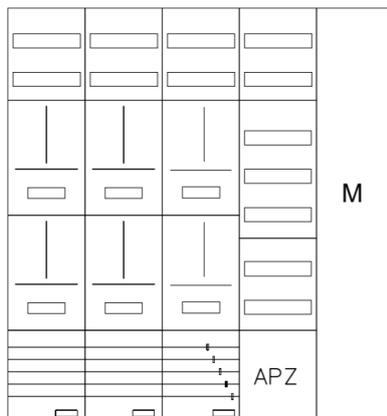
AZ102HS2M2A-230-6, Zählerverteilung mit 3-Punktnach VDE 0603, DIN43870, AR-N 4101:2015 für den Innenbereich für Wandbefestigung AP/UP, Fabr. Alphatec, BxHxT [mm] = 1300x1400x230, Schutzklasse II, IP54, RAL 7035, Bestehend aus: Gehäuse, Einzel- bzw. Doppeltür mit Drehriegel, Flansche SF45 (oben) und SF41 (unten) und Berührungsschutzabdeckungen, aufgebaut wie folgt: 6xZählerplatz, Verteilerfeld (12TE), APZ in Verteilerfeld, Medienfeld, komplett zusammengebaut und verdrahtet gemäß VNB.0207
