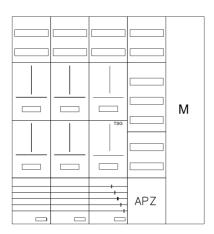
AZ102HS2AM2-230-2, Zählerverteilung mit 3-Punktnach VDE 0603, DIN43870, AR-N 4101:2015 für den Innenbereich für Wandbefestigung AP/UP, Fabr. Alphatec, BxHxT [mm] = 1300x1400x230, Schutzklasse II, IP54, RAL 7035, Bestehend aus: Gehäuse, Einzel- bzw. Doppeltür mit Drehriegel, Flansche SF45 (oben) und SF41 (unten) und Berührungsschutzabdeckungen, aufgebaut wie folgt: 5xZählerplatz, TSG, Verteilerfeld (12TE), APZ in Verteilerfeld, Medienfeld, komplett zusammengebaut und verdrahtet gemäß VNB.0205
