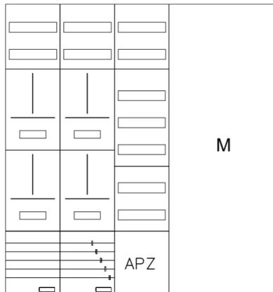
AZ102HS2AM2-210, Zählerverteilung mit 3-Punktbefestigung nach VDE 0603, DIN43870, AR-N 4101:2015 für den Innenbereich für Wandbefestigung AP/UP, Fabr. Alphatec, BxHxT [mm] = 1300x1400x210, Schutzklasse II, IP41, RAL 9016, Bestehend aus: Gehäuse, Einzel- bzw. Doppeltür mit Drehriegel, Flansche NF1 (oben) und NF2 (unten) und Berührungsschutzabdeckungen, aufgebaut wie folgt: 4xZählerplatz, Verteilerfeld (12TE), APZ in Verteilerfeld, Medienfeld, komplett zusammengebaut und verdrahtet gemäß VNB.0083
