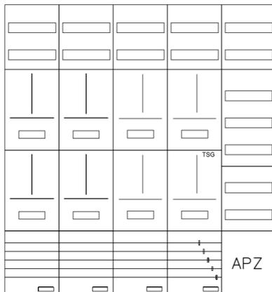
AZ102HS2A-230, Zählerverteilung mit 3-Punktnach VDE 0603, DIN43870, AR-N 4101:2015 für den Innenbereich für Wandbefestigung AP/UP, Fabr. Alphatec, BxHxT [mm] = 1300x1400x230, Schutzklasse II, IP54, RAL 7035, Bestehend aus: Gehäuse, Einzel- bzw. Doppeltür mit Drehriegel, Flansche SF45 (oben) und SF41 (unten) und Berührungsschutzabdeckungen, aufgebaut wie folgt: 7xZählerplatz, TSG, Verteilerfeld (12TE), APZ in Verteilerfeld, komplett zusammengebaut und verdrahtet gemäß VNB.0202
