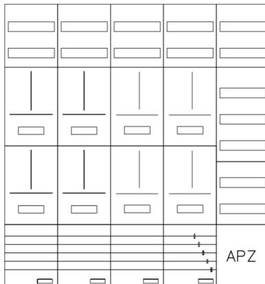
AZ102HS2A-230-8, Zählerverteilung mit 3-Punktnach VDE 0603, DIN43870, AR-N 4101:2015 für den Innenbereich für Wandbefestigung AP/UP, Fabr. Alphatec, BxHxT [mm] = 1300x1400x230, Schutzklasse II, IP54, RAL 7035, Bestehend aus: Gehäuse, Einzel- bzw. Doppeltür mit Drehriegel, Flansche SF45 (oben) und SF41 (unten) und Berührungsschutzabdeckungen, aufgebaut wie folgt: 8xZählerplatz, Verteilerfeld (12TE), APZ in Verteilerfeld, komplett zusammengebaut und verdrahtet gemäß VNB.0203
