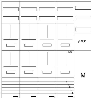
AZ102HS1AM1-210, Zählerverteilung mit 3-Punktbefestigung nach VDE 0603, DIN43870, AR-N 4101:2015 für den Innenbereich für Wandbefestigung AP/UP, Fabr. Alphatec, BxHxT [mm] = 1300x1400x210, Schutzklasse II, IP41, RAL 9016, Bestehend aus: Gehäuse, Einzel- bzw. Doppeltür mit Drehriegel, Flansche NF1 (oben) und NF2 (unten) und Berührungsschutzabdeckungen, aufgebaut wie folgt: 7xZählerplatz, TSG, APZ in Medienfeld, komplett zusammengebaut und verdrahtet gemäß VNB.0077
