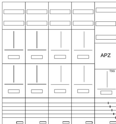
AZ102HS1A-230, Zählerverteilung mit 3-Punktnach VDE 0603, DIN43870, AR-N 4101:2015 für den Innenbereich für Wandbefestigung AP/UP, Fabr. Alphatec, BxHxT [mm] = 1300x1400x230, Schutzklasse II, IP54, RAL 7035, Bestehend aus: Gehäuse, Einzel- bzw. Doppeltür mit Drehriegel, Flansche SF45 (oben) und SF41 (unten) und Berührungsschutzabdeckungen, aufgebaut wie folgt: 8xZählerplatz, TSG, Verteilerfeld (12TE), APZ in Verteilerfeld, komplett zusammengebaut und verdrahtet gemäß VNB.0196
