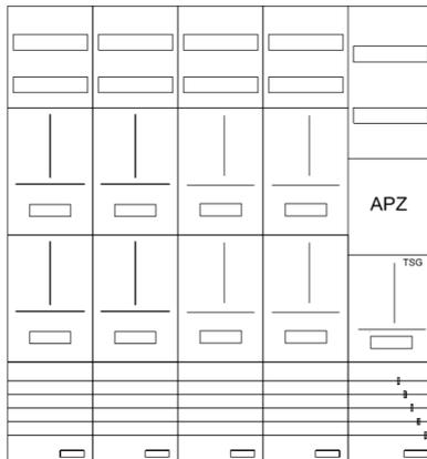
AZ102HS1A-230-9, Zählerverteilung mit 3-Punktnach VDE 0603, DIN43870, AR-N 4101:2015 für den Innenbereich für Wandbefestigung AP/UP, Fabr. Alphatec, BxHxT [mm] = 1300x1400x230, Schutzklasse II, IP54, RAL 7035, Bestehend aus: Gehäuse, Einzel- bzw. Doppeltür mit Drehriegel, Flansche SF45 (oben) und SF41 (unten) und Berührungsschutzabdeckungen, aufgebaut wie folgt: 8xZählerplatz, TSG, Verteilerfeld (12TE), APZ in Verteilerfeld, komplett zusammengebaut und verdrahtet gemäß VNB.0197
