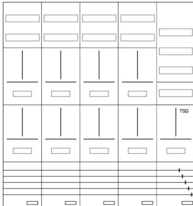
AZ102HS1-230-9, Zählerverteilung mit 3-Punktnach VDE 0603, DIN43870, AR-N 4101:2015 für den Innenbereich für Wandbefestigung AP/UP, Fabr. Alphatec, BxHxT [mm] = 1300x1400x230, Schutzklasse II, IP54, RAL 7035, Bestehend aus: Gehäuse, Einzel- bzw. Doppeltür mit Drehriegel, Flansche SF45 (oben) und SF41 (unten) und Berührungsschutzabdeckungen, aufgebaut wie folgt: 9xZählerplatz, Verteilerfeld (12TE), externer APZ erforderlich, komplett zusammengebaut und verdrahtet gemäß VNB.0150
