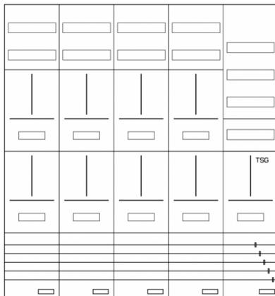
AZ102HS1-210-9, Zählerverteilung für Zählerplatz mit 3-Punktbefestigung nach VDE 0603, DIN43870, AR-N 4101:2015 für den Innenbereich für Wandbefestigung AP/UP, Fabr. Alphatec, BxHxT [mm] = 1300x1400x210, Schutzklasse II, IP41, RAL 9016, Bestehend aus: Gehäuse, Doppeltür mit Drehriegel, Flansche NF1 (oben) und NF2 (unten) und Berührungsschutzabdeckungen, aufgebaut wie folgt: 9x Zählerplatz, 5x Hutschienen in Verteilerfeld 1 (12TE), komplett zusammengebaut und verdrahtet gemäß VNB.0001
