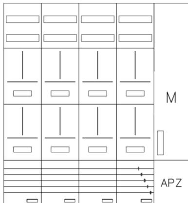
AZ102HM2A-230, Zählerverteilung mit 3-Punktnach VDE 0603, DIN43870, AR-N 4101:2015 für den Innenbereich für Wandbefestigung AP/UP, Fabr. Alphatec, BxHxT [mm] = 1300x1400x230, Schutzklasse II, IP54, RAL 7035, Bestehend aus: Gehäuse, Einzel- bzw. Doppeltür mit Drehriegel, Flansche SF45 (oben) und SF41 (unten) und Berührungsschutzabdeckungen, aufgebaut wie folgt: 8xZählerplatz, APZ in Medienfeld, komplett zusammengebaut und verdrahtet gemäß VNB.0195
