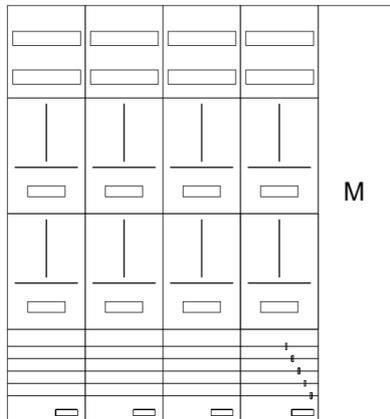
AZ102HM2-230, Zählerverteilung mit 3-Punktnach VDE 0603, DIN43870, AR-N 4101:2015 für den Innenbereich für Wandbefestigung AP/UP, Fabr. Alphatec, BxHxT [mm] = 1300x1400x230, Schutzklasse II, IP54, RAL 7035, Bestehend aus: Gehäuse, Einzel- bzw. Doppeltür mit Drehriegel, Flansche SF45 (oben) und SF41 (unten) und Berührungsschutzabdeckungen, aufgebaut wie folgt: 8xZählerplatz, Medienfeld, externer APZ erforderlich, komplett zusammengebaut und verdrahtet gemäß VNB.0194
