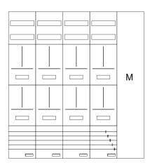
AZ102HM2-210, Zählerverteilung mit 3-Punktbefestignach VDE 0603, DIN43870, AR-N 4101:2015 für den Innenbereich für Wandbefestigung AP/UP, Fabr. Alphatec, BxHxT [mm] = 1300x1400x210, Schutzklasse II, IP41, RAL 9016, Bestehend aus: Gehäuse, Einzel- bzw. Doppeltür mit Drehriegel, Flansche NF1 (oben) und NF2 (unten) und Berührungsschutzabdeckungen, aufgebaut wie folgt: 8xZählerplatz, Medienfeld, externer APZ erforderlich, komplett zusammengebaut und verdrahtet gemäß VNB.0073
