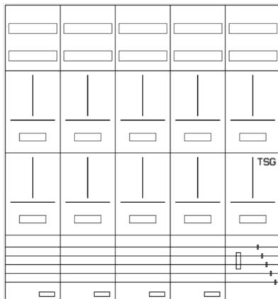
AZ102H-210, Zählerverteilung für Zählerplatz mit 3-Punktbefestigung nach VDE 0603, DIN43870, AR-N 4101:2015 für den Innenbereich für Wandbefestigung AP/UP, Fabr. Alphatec, BxHxT [mm] = 1300x1400x210, Schutzklasse II, IP41, RAL 9016, Bestehend aus: Gehäuse, Doppeltür mit Drehriegel, Flansche NF1 (oben) und NF2 (unten) und Berührungsschutzabdeckungen, aufgebaut wie folgt: 9x Zählerplatz, 1x TSG-Platte, komplett zusammengesetzt und verdrahtet gemäß VNB.0001
