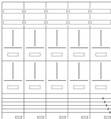
AZ102H-210-10, Zählerverteilung für Zählerplatz mit 3-Punktbefestigung nach VDE 0603, DIN43870, AR-N 4101:2015 für den Innenbereich für Wandbefestigung AP/UP, Fabr. Alphatec, BxHxT [mm] = 1300x1400x210, Schutzklasse II, IP41, RAL 9016, Bestehend aus: Gehäuse, Doppeltür mit Drehriegel, Flansche NF1 (oben) und NF2 (unten) und Berührungsschutzabdeckungen, aufgebaut wie folgt: 10x Zählerplatz, komplett zusammengebaut und verdrahtet gemäß VNB.0001
