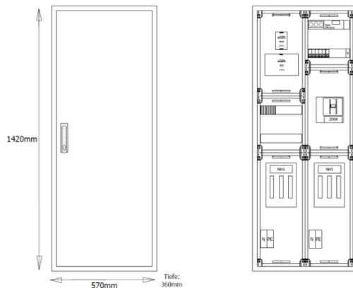
AVKNA120-2-9-360 V-Automatenverteiler, AVK, BxHxT = 570x1420x360 Schutzklasse II, IP54, RAL 7035, Aufputz Bestehend aus:Gehäuse, Einzeltür mit Schwenkhebel für PHZ, Flansche SF32 (oben) und SF39 (unten), 1x Geräteträger mit Feldabdeckungen PRL best. mit
