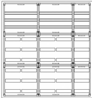
AVK5-9-230-S Automatenverteiler, AVK, BxHxT = 1300x1400x230 Schutzklasse II, IP54, RAL 7035, Aufputz
