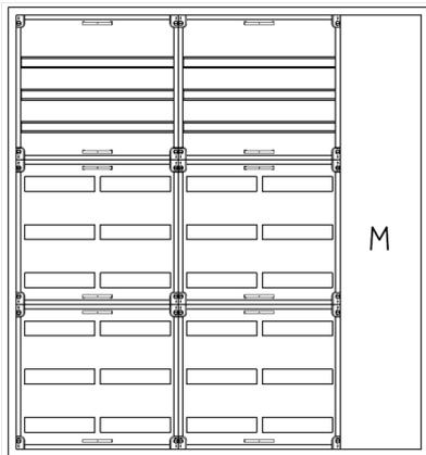
AVK5-9-230-M1-PAutomatenverteiler, AVK, BxHxT = 1300x1400x230Schutzklasse II, IP54, RAL 7035, AufputzBestehend aus:Gehäuse, Doppeltür mit Schwenkhebel für PHZ, Flansche SF45(oben) und SF41 (unten), 2x Geräteträger 2-Feld breit 3/6 mit Feldabdeckungen PS, 1x Montageplatte 1-Feld breit
