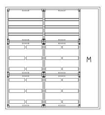
AVK5-9-210-M1-PAutomatenverteiler, AVK, BxHxT = 1300x1400x210Schutzklasse II, IP41, RAL 9016, AufputzBestehend aus:Gehäuse, Doppeltür mit Drehriegel, Flansche NF1(oben) und NF2 (unten), 2x Geräteträger 2-Feld breit 3/6 mit Feldabdeckungen PS, 1x Montageplatte 1-Feld breit
