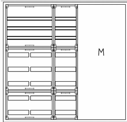
AVK5-8-230-M2 Automatenverteiler, AVK, BxHxT = 1300x1250x230 Schutzklasse II, IP54, RAL 7035, Aufputz
