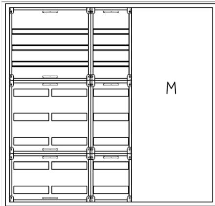
AVK5-8-210-M2 Automatenverteiler, AVK, BxHxT = 1300x1250x210 Schutzklasse II, IP41, RAL 9016, Aufputz
